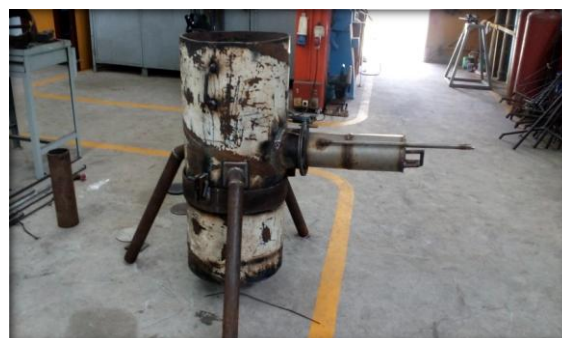
Gambar 1. Pemasangan Smart Burner pada Continuous Furnace
