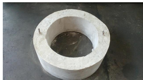
Gambar 4: Hasil cetakan batu tahan api dari Castable
